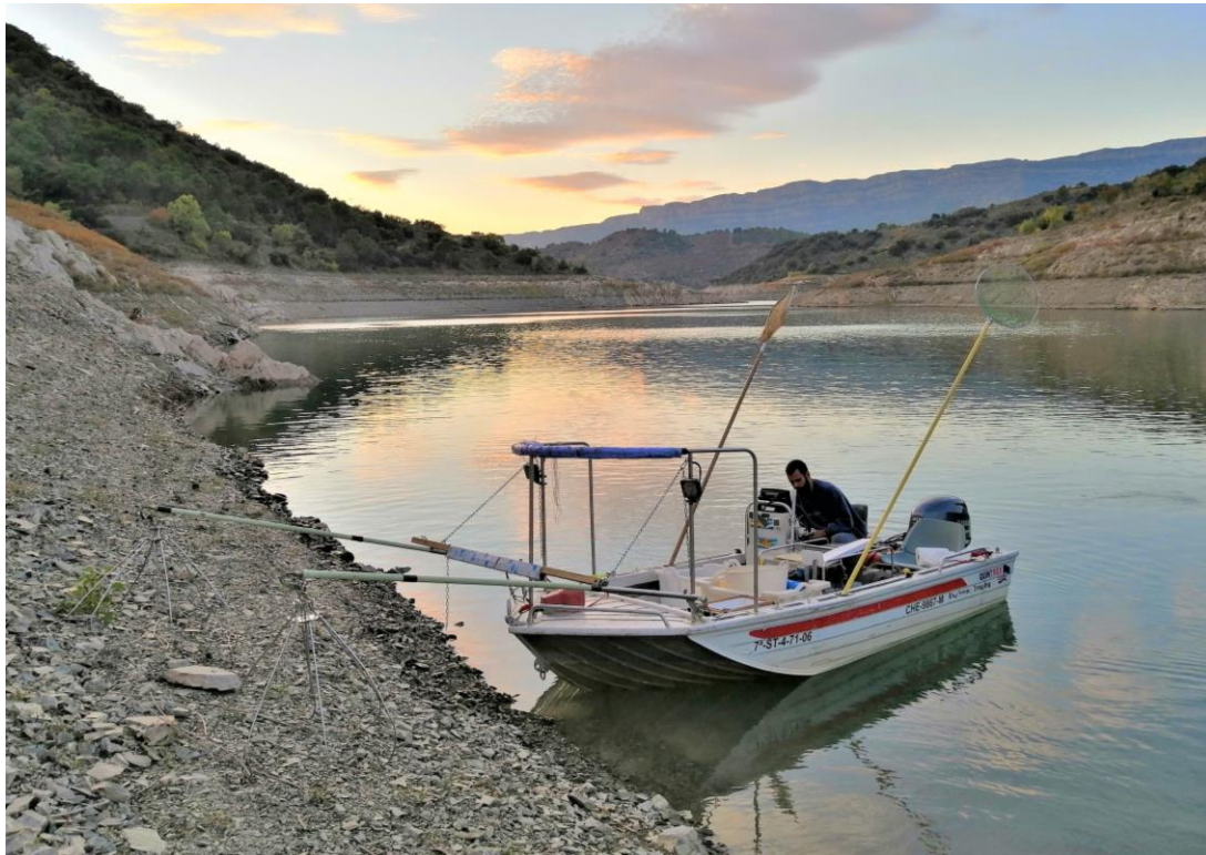
Figura 10. Equipo de electropesca en embarcación preparado para el muestreo en el embalse de Ciurana
