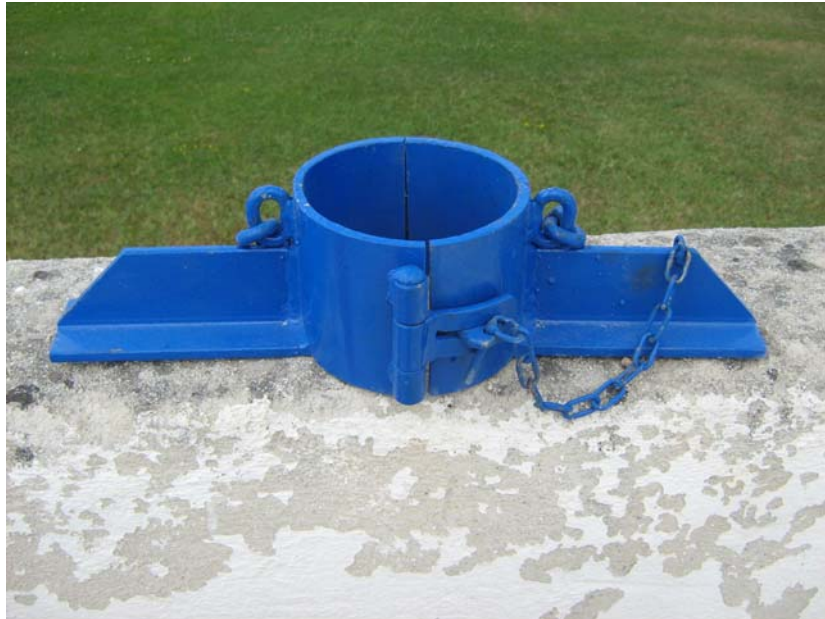
Pieza definitiva que sujetará la tubería. Vista frontal
