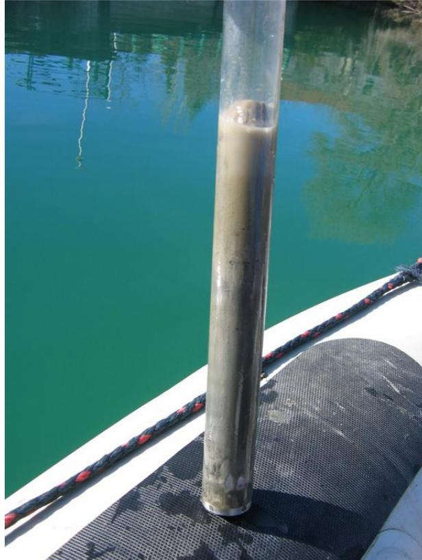
**Figura 3.-** Muestra extraída con el corer de gravedad utilizado en el muestreo.
