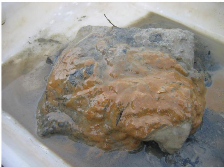
Contiene una matriz superior limosa, de 1 cm de grosor, con una coloración rojiza-anaranjada. La matriz inferior es limosa gris, poco compacta, y a continuación pasa a ser arenosa. Se observa la presencia de hidrocarburos y de metano. Sin olor.
