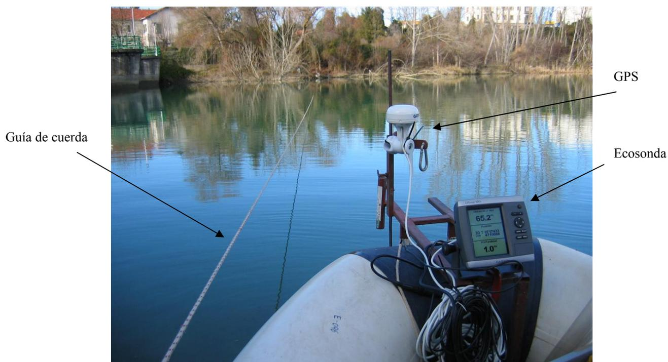
**Figura 2.-** Guía de cuerda a lo largo de la cual se iban tomando profundidades cada 2m, y detalle de la ecosonda.
