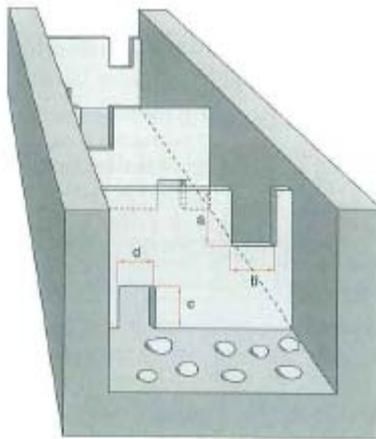
Fig. 10. Vista de una escala de estanques sucesivos. (Larinier 1992)
