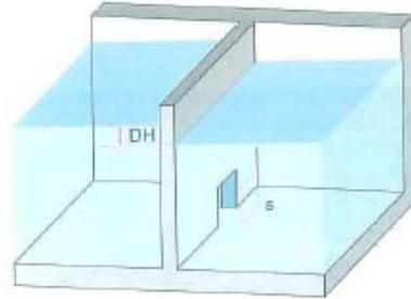
La principal función del orificio de limpieza es fundamentalmente permitir la salida de gravas de las artesas, impidiendo su colmatación.
