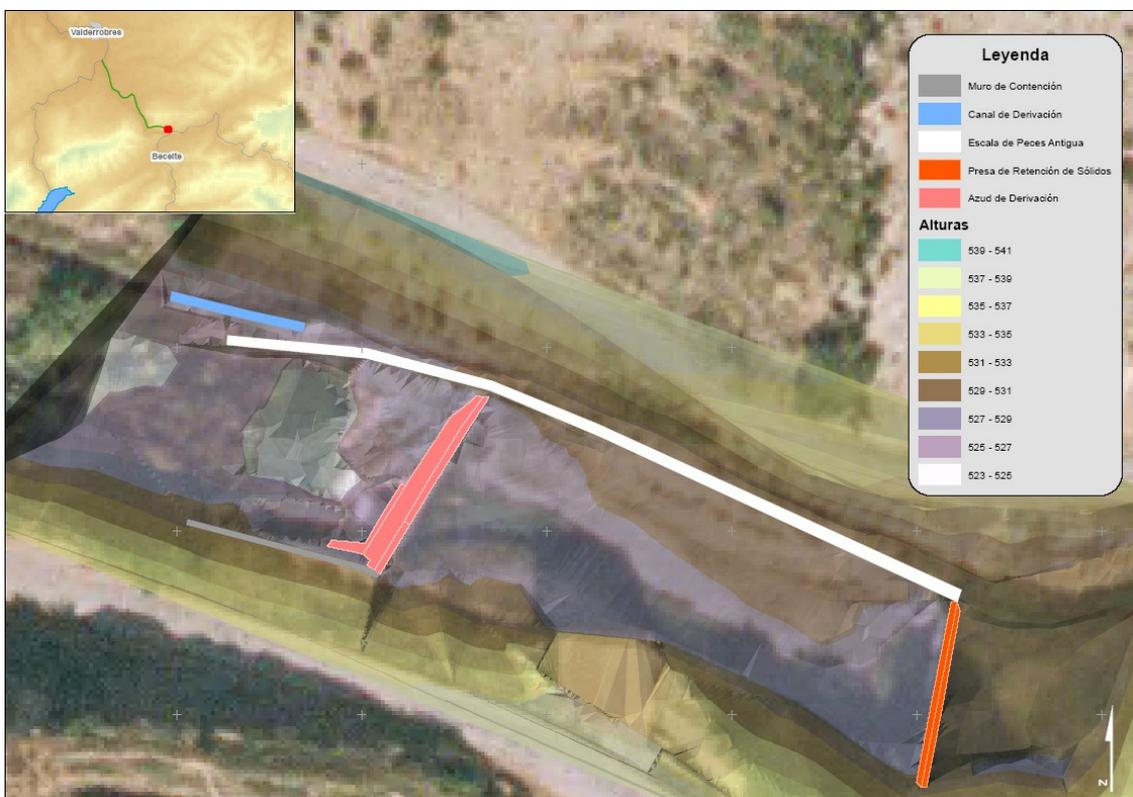
Fig. 7. Modelo digital del terreno en el entorno del azud
