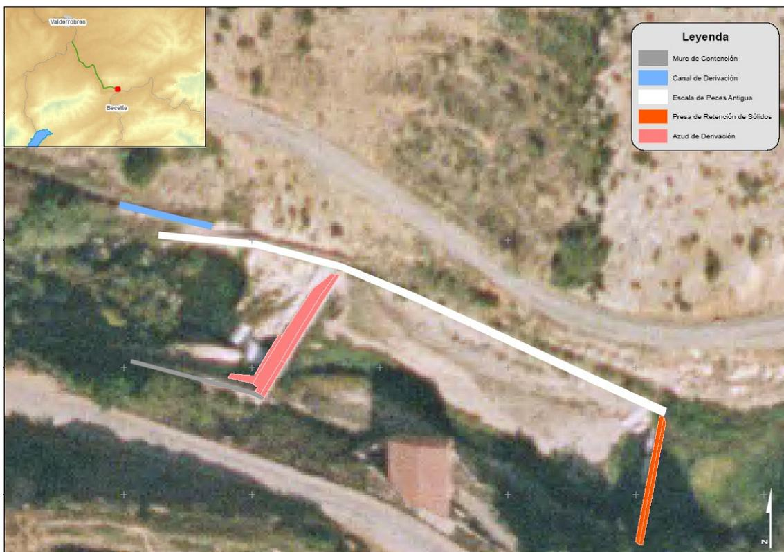
Fig. 6. vista en planta del azud de derivación y la presa de retención de sólidos
