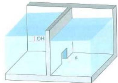
La principal función del orificio de limpieza es fundamentalmente permitir la salida de gravas de las artesas, impidiendo su colmatación.
