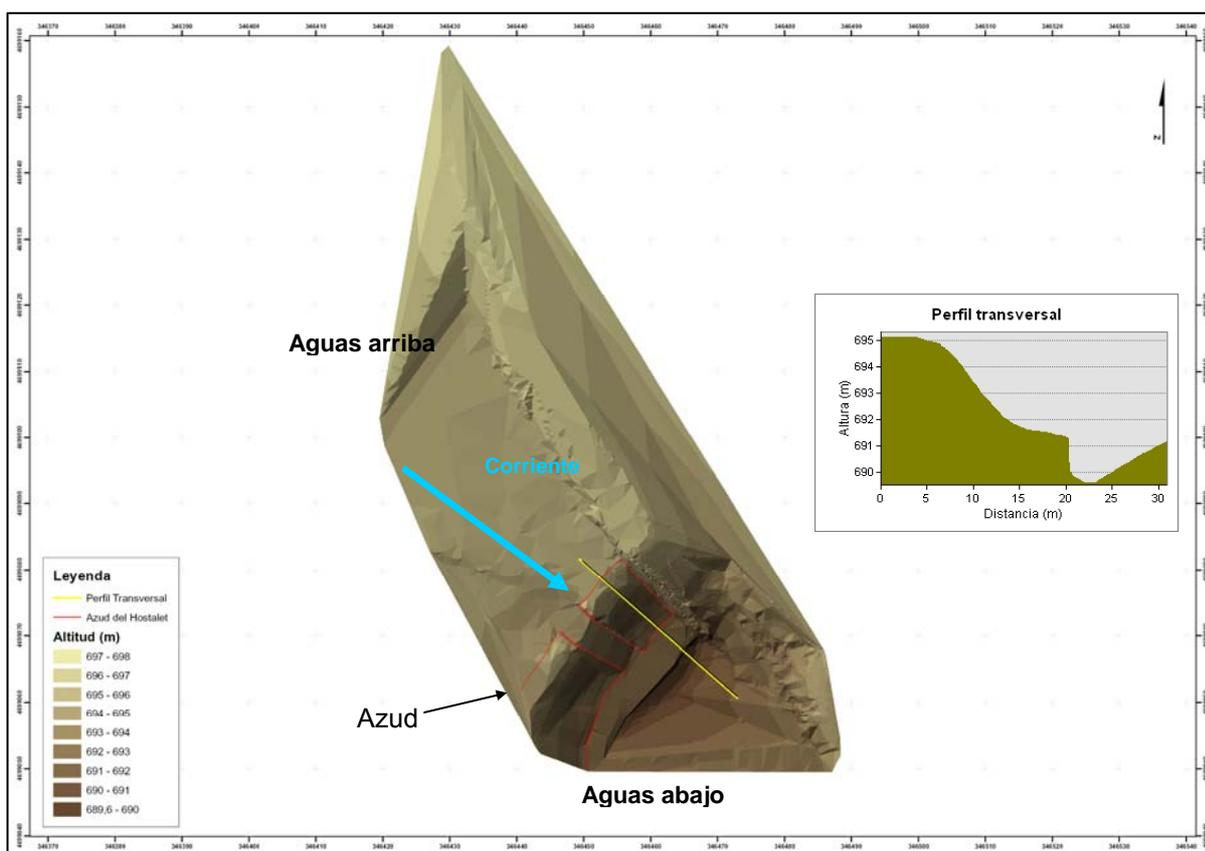
Fig. 6. Modelo Digital de Terreno y Perfil transversal del azud
