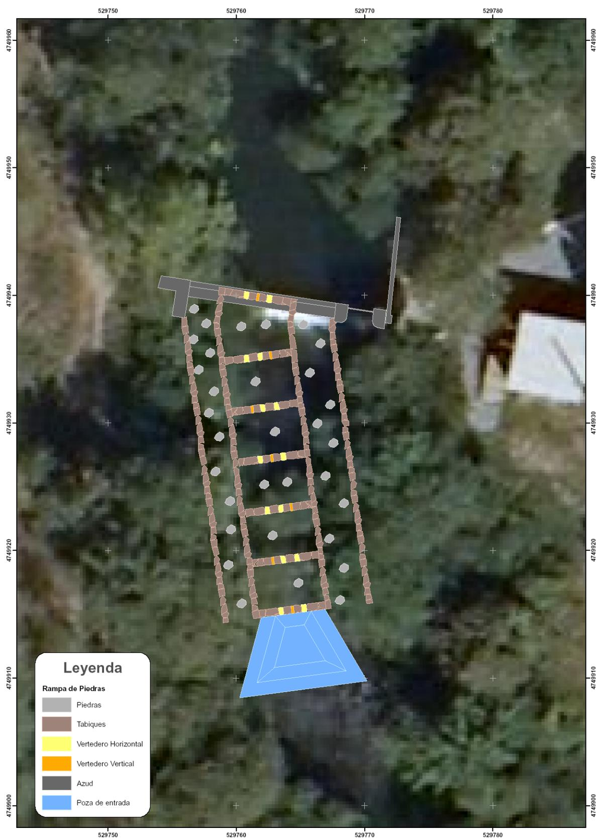
Fig. 7. planta del azud y la rampa de piedras diseñada
