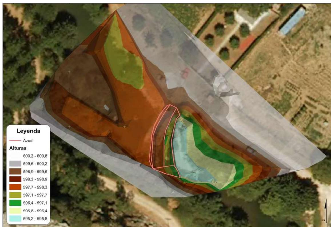
Fig. 11. Modelo digital del terreno en el entorno del azud
