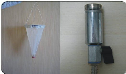
Figura 1. Arriba. Utensilios de muestreo: Izquierda, red de plancton de 50 \mu\text{m} , derecha, receptor del material filtrado.
