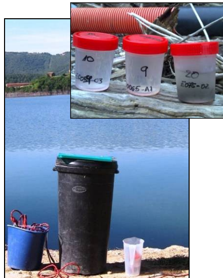
Figura 1. Arriba. Utensilios de muestreo: Izquierda, red de plancton de 50 \mu\text{m} , derecha, receptor del material filtrado.
