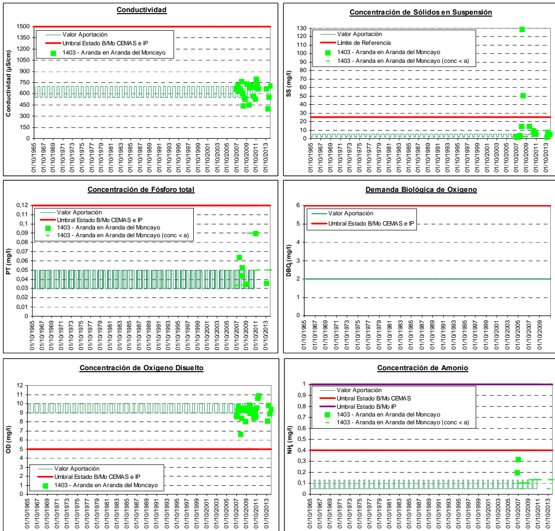
Figura 32. Concentración de los constituyentes modelados de la aportación relativa al río Aranda en el embalse de Maidevera (“Aranda”).
