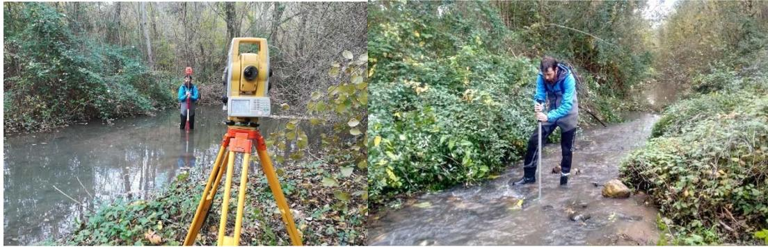
**Figura 4.-** Ejemplo de caracterización de un transecto mediante levantamiento topográfico (**izquierda**) y mediante la medición de la velocidad del flujo (**derecha**).
