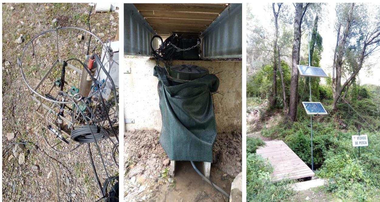
**Figura 22.** Instalación de la estación 2 en el punto R1, fotos de izquierda a derecha: Armazón con sensores; instalación y sistema de alimentación energética solar
