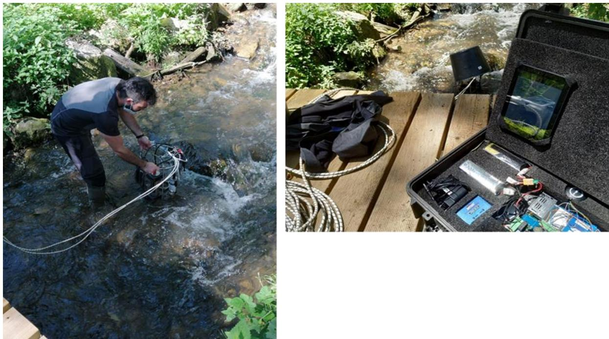
**Figura 15.** Dispositivo portátil de medición en el río Val (R1). Sondas y sensores en el cauce (izquierda) y sistema de adquisición y control (derecha)
