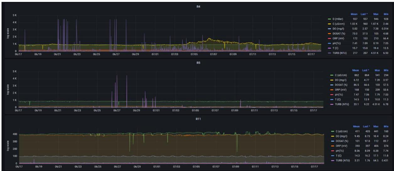
**Figura 20.** Adquisición de datos almacenados en la nube a través de la plataforma Grafana de todos los parámetros monitorizados en los puntos de monitorización remota R4, R5 y R11 durante un periodo de 1 mes.
