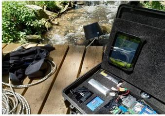
**Figura 1.** Dispositivo portátil de medición en el río Val. Sondas y sensores en el cauce (izquierda) y sistema de adquisición y control (derecha)
