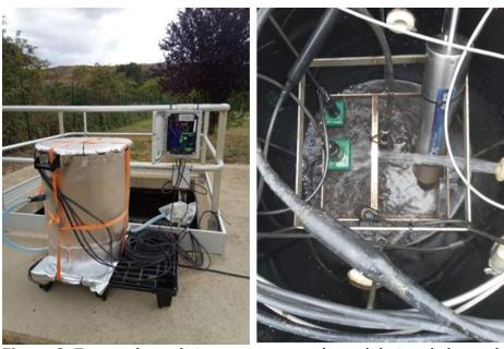
**Figura 2**. Tanque de mediciones y sensores de medida instalados en la arqueta de vertido de la EDAR
